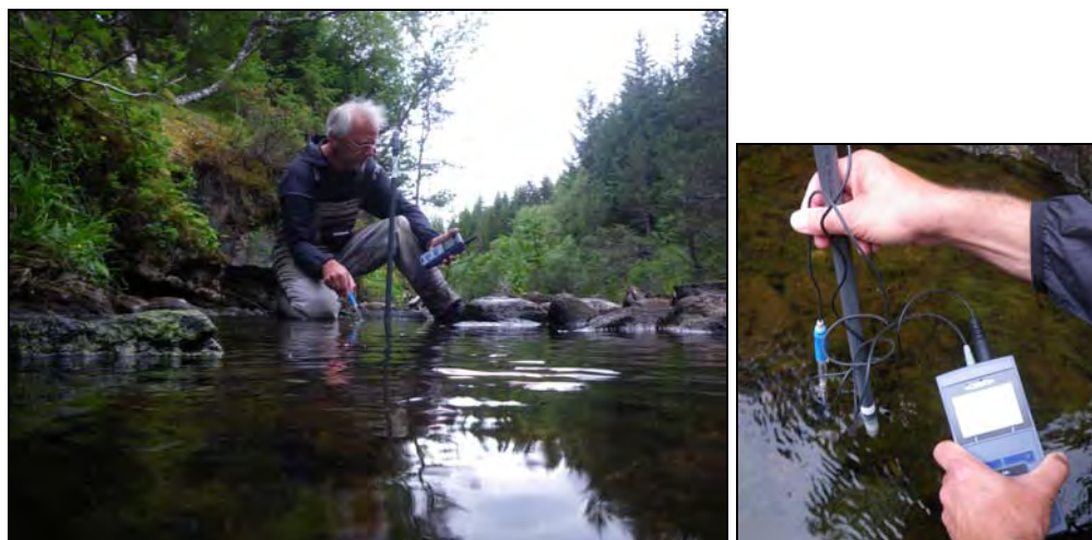
Utstyret som benyttes til målinger av redokspotensiale består av en 0,7 m lang sonde, en referanse-elektrode og et voltmeter. Måling av redokspotensiale i Hestadelva, Nordland. Foto: Jon M. Bjerland.
