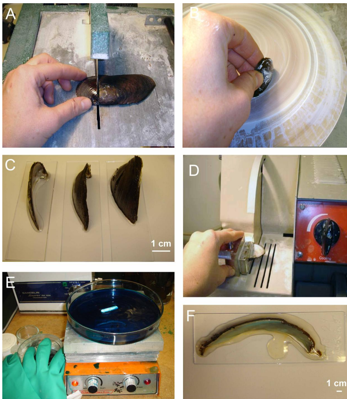
Figur 3. A- Musselskalen sågades vinkelrätt mot vinterlinjerna från den ventrala kanten till umbo med hjälp av en diamantklinga; B- Polering av skalsnittet; C- Skalbitarna klistrades fast på objektglas; D- Skalen sågades så att ett tunt skalsnitt (ca 0,5 mm) blev kvar på objektglaset; E- Etsning med Mutvei's blandning; F- Färdig slipsnitt.
