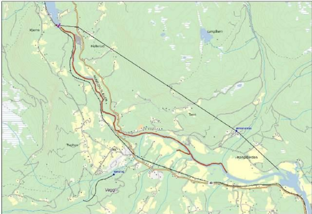
Figur 15: Oversikt over strekningen Kjerredammen - Kongsjorden som er karakterisert som SMVF (oransje) samt overføringstuneller (svart strek) og kraftverk (blå firkant).
