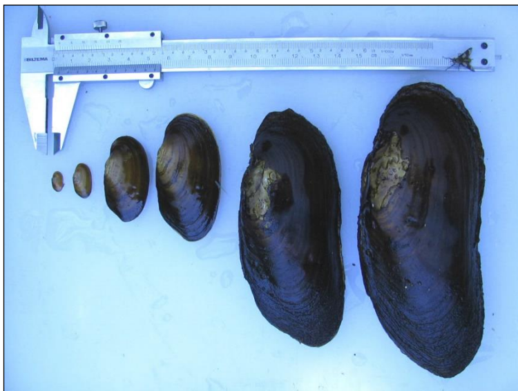
Figur 7. Lengdemåling av elvemusling skjer med skyvelære til nærmeste 0,1 mm. Den minste muslingen som ble funnet i Simoa i 2017 var om lag 13 millimeter. Den største var over 15 centimeter. Foto: Bjørn Mejdell Larsen.
