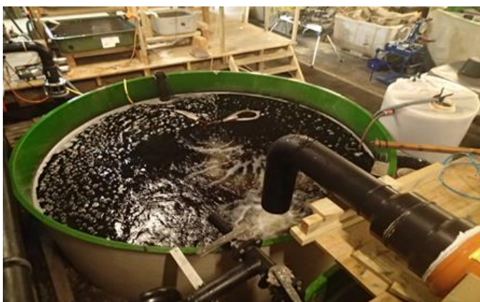
Fig 6. Vannet fra trommelfilteret blir luftet i ett 9 m 3 kar og tilført kalsium med en doseringspumpe før det pumpes ut til stammusling karene. Karet blir også brukt til å tilføre mat til muslingene
