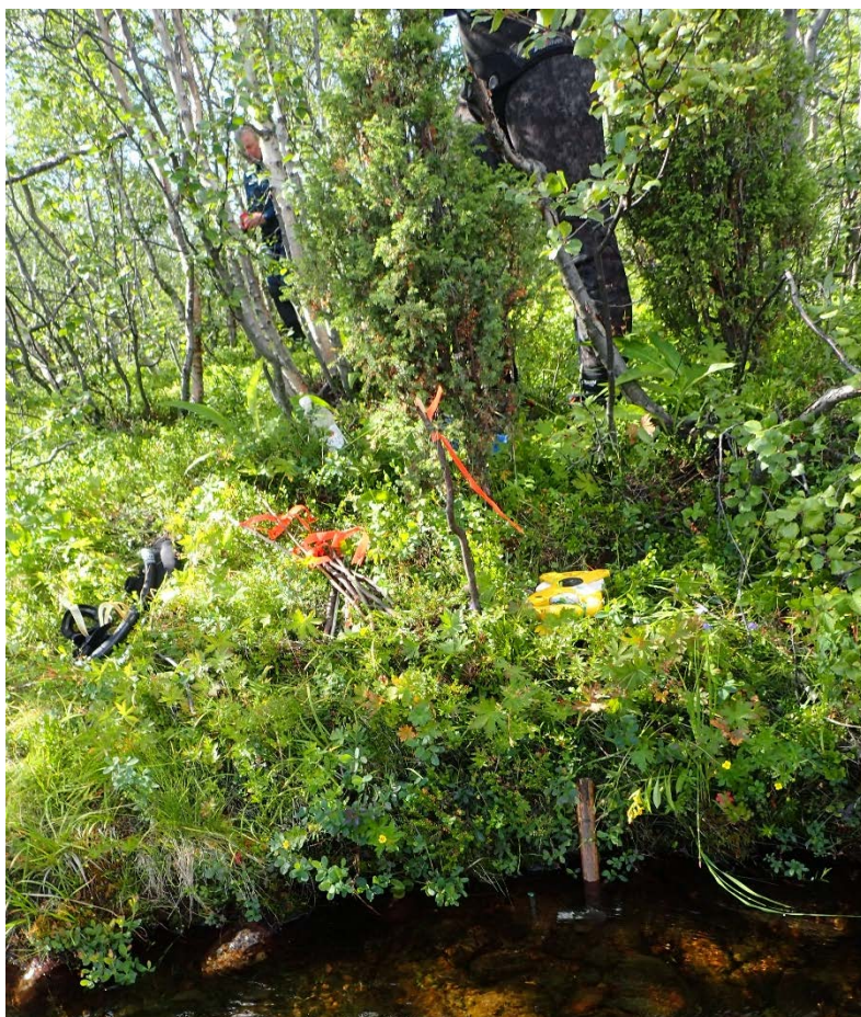
Figur 6ABC. På figur 6A så ser vi hammer og staget som er geopunkt, nede i vannet under målemerket, Figur 6B viser nærbilde av nedbanket stag i strandlinjen og figur 6C (Foto Juho Vuolteenaho) er geopunkt banket ned i bunnen ute i elva.
