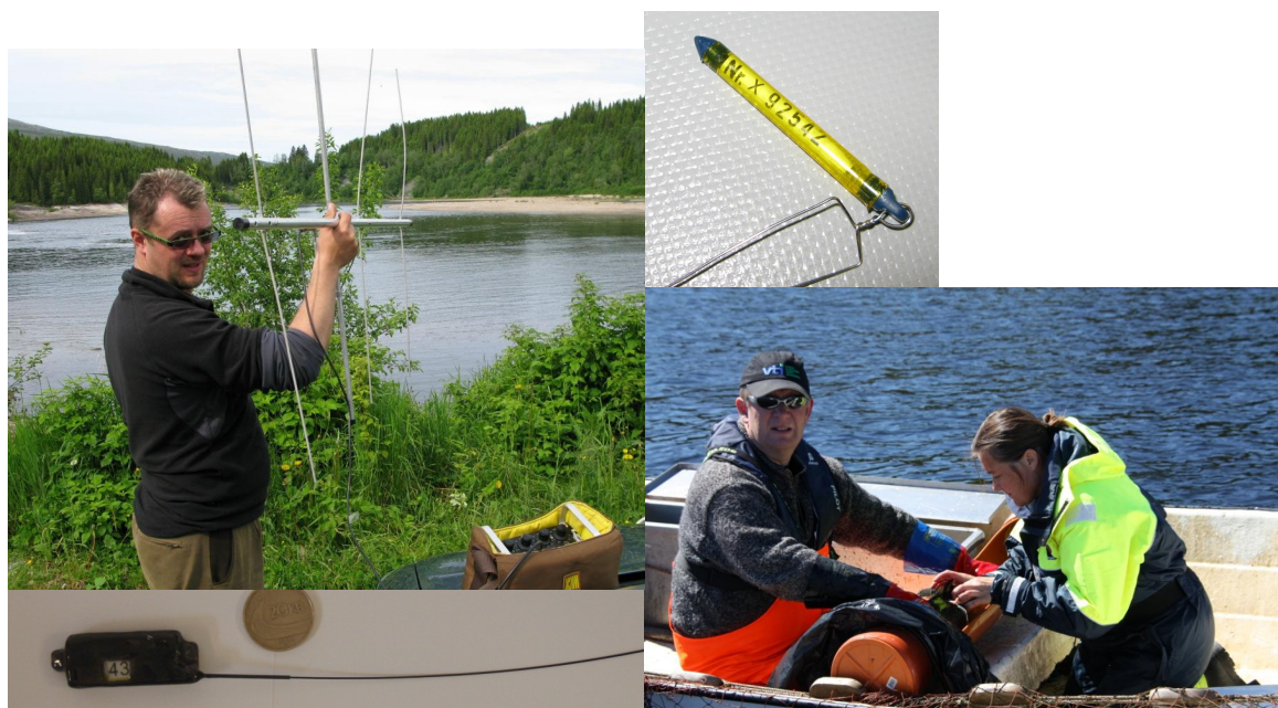
Bilder: øverst til venstre: manuell peiling av laks, øverst til høyre: lea-merke, nederst til venstre: radiosender, nederst til høyre: merking av laks tatt i kilenot.
