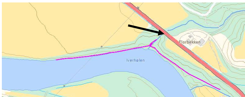
Figur 22. Oversiktskart som viser kulvertens plassering (pil) der E14 krysser Florbekken. Sikringstiltak er markert med røde linjer.
