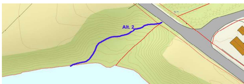
Figur 24. Alternativ trasé (blå strek) ved omlegging av Florbekken nedstrøm E14. Dagens trasé følger den røde streken på kartet.
