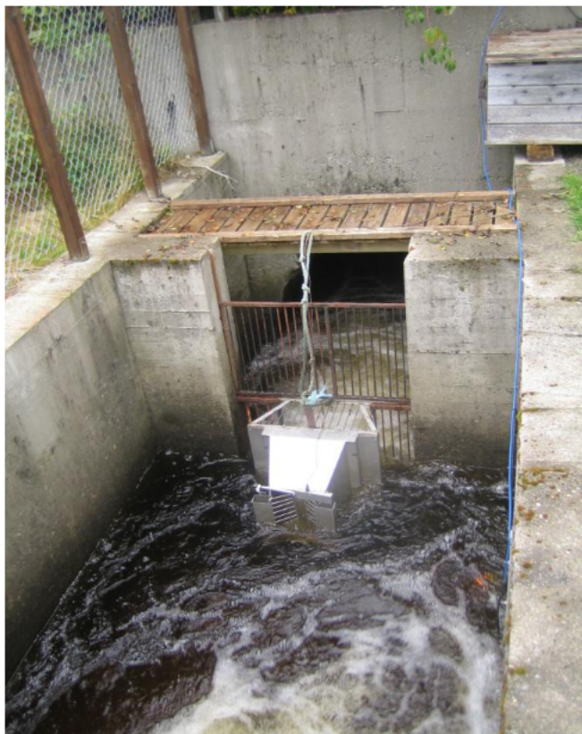
Figur 2. Fisketellerens plassering i trappa. Ved stor vannføring gjør mye bobler foran kamera det vanskelig og i enkelte tilfeller umulig å avgjøre om det er fisk som passerer eller ikke.
