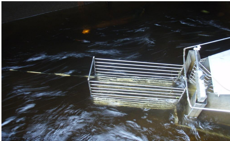
Figur 4. Bildet viser kalven påmontert lengdestav inndelt i 10 cm svarte og gule felt, med kamera og lys i bakgrunn.
