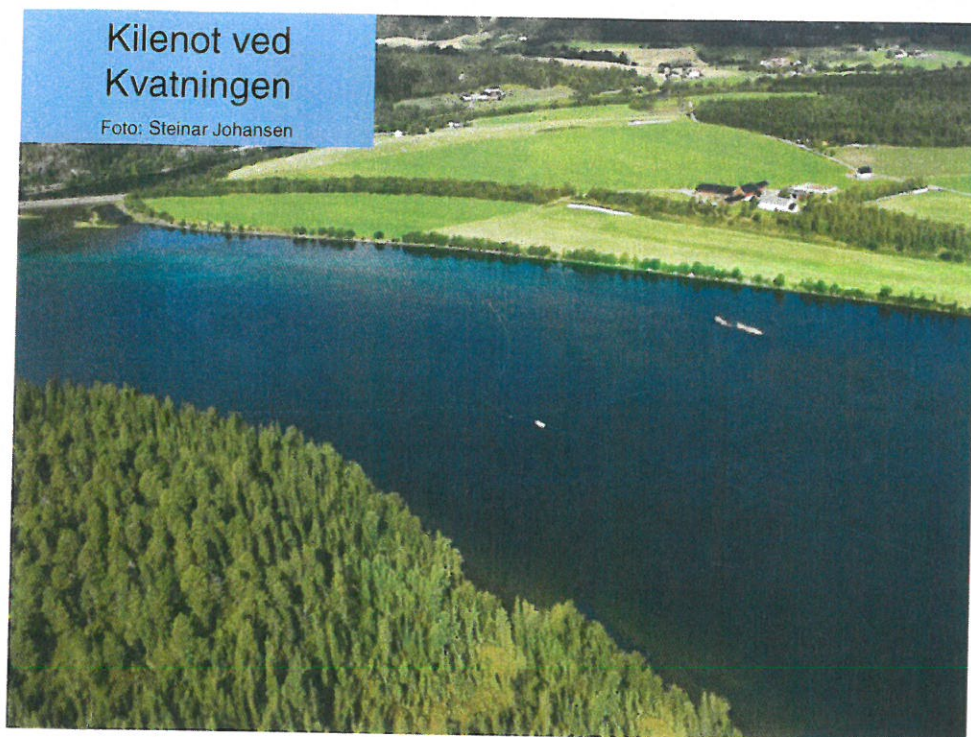
Figur 1. Kilenot benyttet til utfisking av rømt oppdrettslaks ved Kvatningen, Namsenvassdraget 2008. Fangstkammeret sees i midten, derfra går ledegarn inn mot hver elvebredde. Foto: Steinar Johansen
