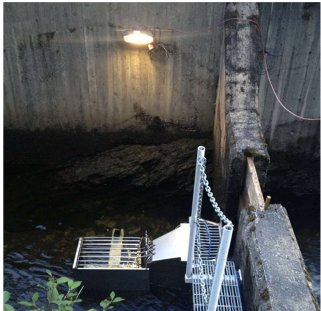
Figur 1. Bildet viser oppsett av fisketeller med videokamera og lys i laksetrappa.
